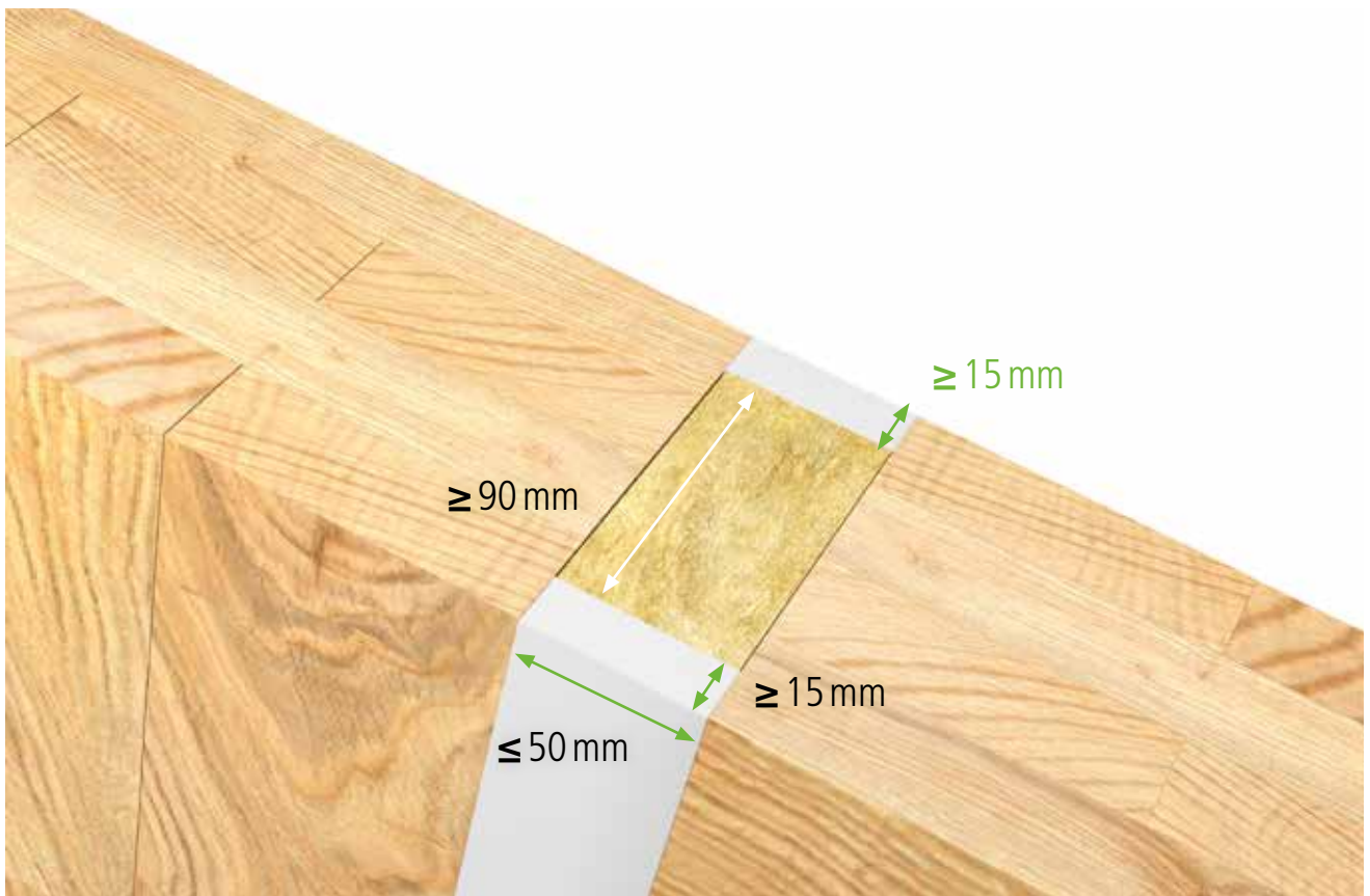
A.9.1. Fugenabdichtung zwischen Holzelementen \geq 120 mm
