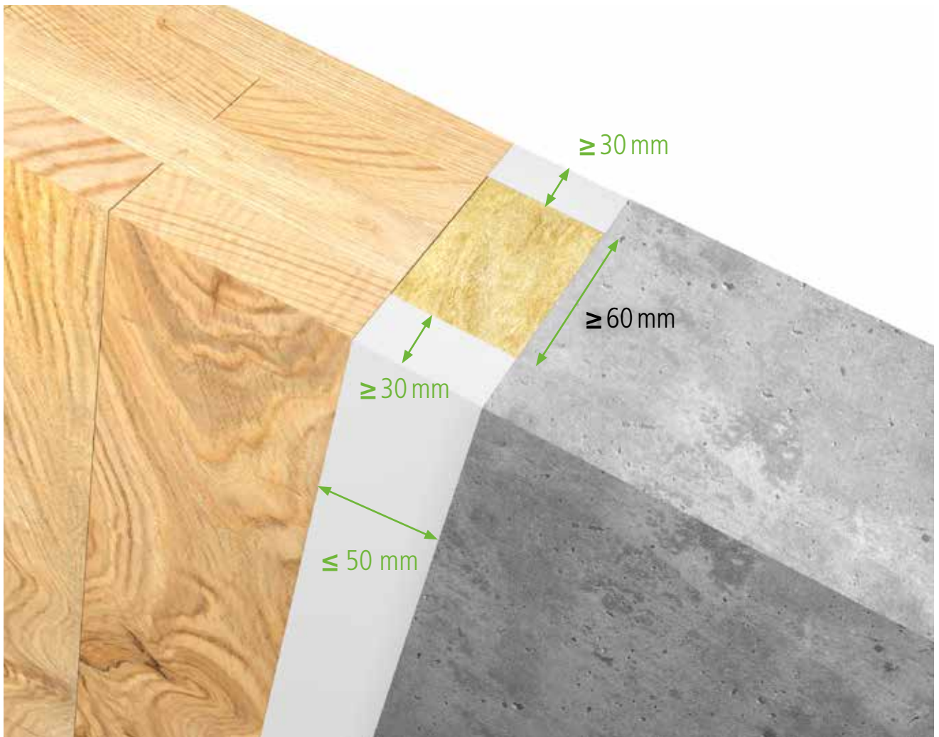
A.7.1. Fugenabdichtung \leq 50 mm zwischen Holzelement \geq 120 mm und Massivwand \geq 150 mm
