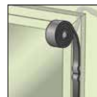
Stumpfstoß bei der Fenstermontage
