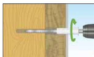
Fertig eindrehen bis der Kragen des Entkoppelungselements bündig am Putz anliegt.
