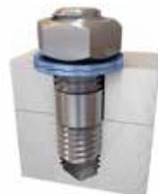
Nord-Lock für Stiftschrauben. Die Sicherung der Mutter erfolgt, ohne dass ein Einkleben der Stiftschraube notwendig wird.
