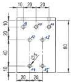
Abb. B. 61 Abmessungen des Winkelverbinders 618 166 40
