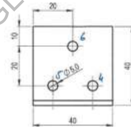
Abb. B. 62 Abmessungen des Winkelverbinders 618 168 40
