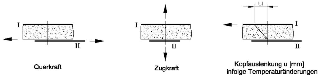
Gewindeformende Schrauben zur Verbindung von Sandwichelementen mit Unterkonstruktionen aus Stahl oder Holz
