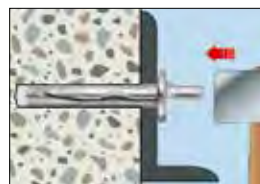
3. Deckennagel durch das Anbauteil stecken und Stift bündig einschlagen.
