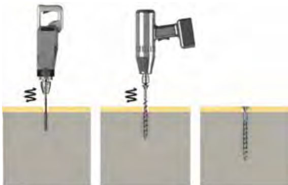
Montage mit Vorbohren
