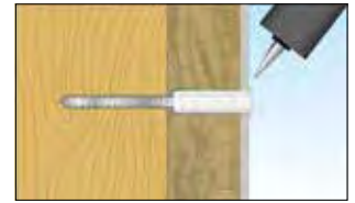
Spalt zwischen Putz und Entkopplungselement mit geeignetem Dichtstoff abdichten.
