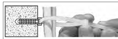
Kabelband bis 9 mm Breite durchführen und befestigen
