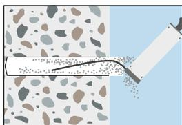
2. Bohrloch reinigen.
