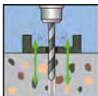
2. Bohrloch reinigen
