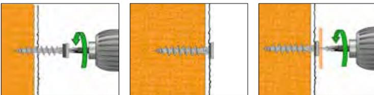
Verwendbar mit Schrauben  $\varnothing 3,5\text{ mm}$ ; Schraubenlänge  $10\text{ mm} + \text{Anbauteildicke}$
