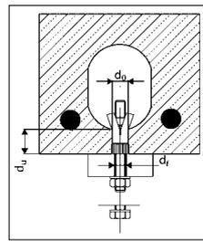
**Hohlkammer:** Beim Anziehen der Mutter oder Schraube wird der Konus in die Hülse gezogen, die sich dadurch in der Hohlkammer aufspreizt.
