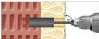
Anbohrhilfe zum Anbohren der ersten 10 mm des Mauerwerks nochmal einsetzen, anschließend wieder entfernen und bis Bohrlochtiefe min. 130 mm im Drehbohrverfahren weiterbohren.
