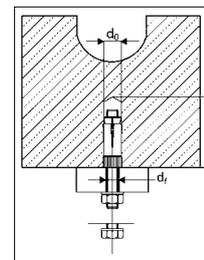
**Massivzone:** Beim Anziehen der Mutter oder Schraube presst der Konus die Hülse gegen die Bohrlochwand.
