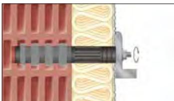
Den Gewinde-Schutzstopfen entfernen.
