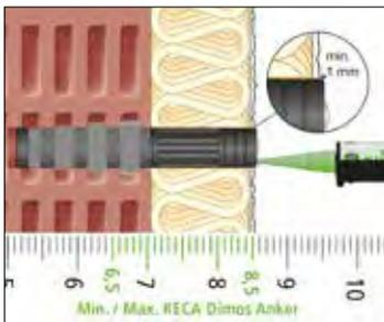
RECA Dimos Anker mit Injektionsmörtel RECA VMU plus 330 befüllen.
