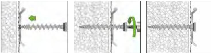
Vorsteckmontage (leichte Befestigung mittels Schraube)
