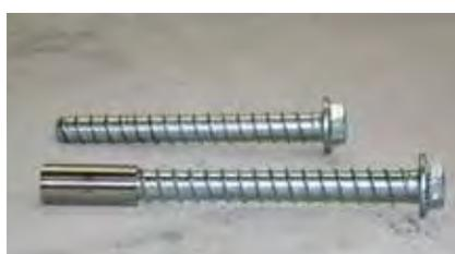
Schraube zur Weiterverwendung geeignet
