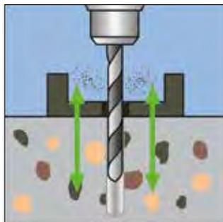
2. Bohrloch reinigen
