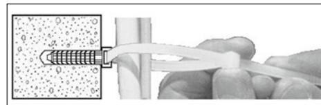
Kabelband bis 9 mm Breite durchführen und befestigen
