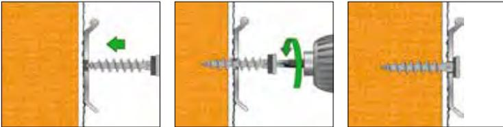
Vorsteckmontage (leichte Befestigung mittels Schraube)
