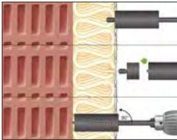
Mit der RECA Dimos Anker Bohrkronen oder einer Bohrkronen  $\varnothing$  39-40 mm durch die Dämmung bis zum Mauerwerk im Drehbohrverfahren bohren. Empfohlene Drehzahl: 1.000-1.500 U/min.
