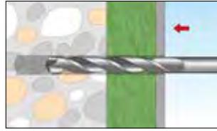
2. Bohrloch mit  $\varnothing$  14 mm im Baustoff erstellen. Bohrlochtiefe: 90 mm +  $t_{WDVS}$
