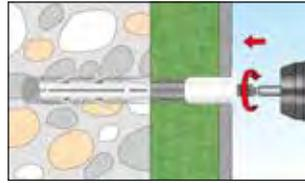
6. Fertig eindrehen bis der Kragen des Entkoppelungselements bündig am Putz anliegt. Spalt zwischen Putz und Entkoppelungselement mit geeignetem Dichtstoff abdichten.
