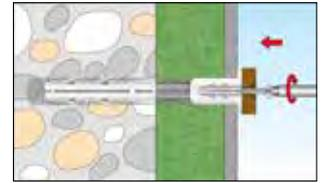
9.3 Befestigung des Anbauteils mit einer  $\varnothing$  3,0 - 4,5 mm Schraube.
