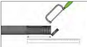
Bei Bedarf RECA Dimos Anker mittels einer Metallsäge o. ä. bis max. 40 mm ablängen.
