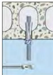
4. Schraube oder Mutter mit vorgeschriebenen Drehmoment anziehen.
