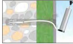
3. Bohrloch reinigen.
