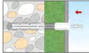
8.3. Dübel 5/25 mm in das Entkoppelungselement einschlagen.
