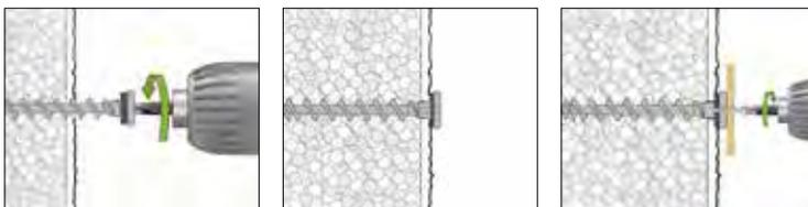
Verwendbar mit Schrauben  $\varnothing$  3,5 mm; Schraubenlänge 10 mm + Anbauteildicke
