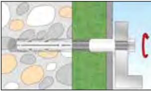
8.2. Befestigung des Anbauteils mit M6 Schraube.
