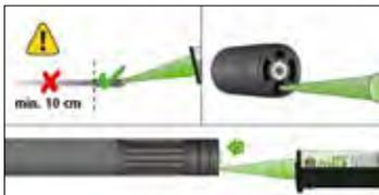
Die Mischdüse auf die Kartusche schrauben, die Kartusche in eine geeignete Auspresspistole einlegen und die ersten 10 cm der ausgepressten Mörtelmasse verwerfen.
