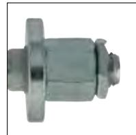
Große, dicke Abdeckscheibe zur großflächigen Kraftübertragung. Die extra hohe Mutter verhindert zusammen mit der Kontermutter zuverlässig das Lösen der Verschraubung bei Vibrationen.
