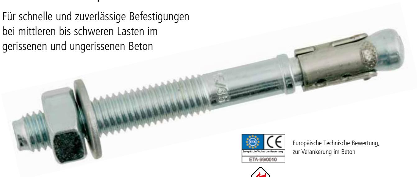
Der Bolzenanker BZ plus ist ein kraftkontrolliert spreizender Dübel für die schnelle Montage. Beim Anziehen der Sechskantmutter wird der Bolzen in den Spreizclip gezogen und verspannt diesen zuverlässig gegen die Bohrlochwand.
