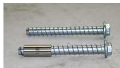
Hülse lässt sich komplett aufstecken, Schraube für Weiterverwendung nicht mehr geeignet
