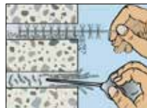
2. Bohrlöcher sorgfältig mit Stahlbürste und Ausbläser reinigen
