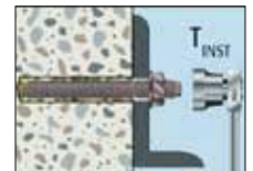
6. Bauteil befestigen, vorgeschriebenes Drehmoment aufbringen
