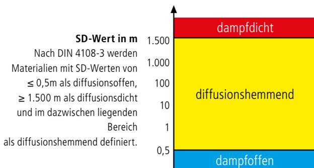
Der SD-Wert beschreibt die Wasserdampfdurchlässigkeit und setzt sich zusammen aus dem materialspezifischen Kennwert ( $\mu$ -Wert) und der Materialdicke in Metern:  $SD = \mu \times s$ .
