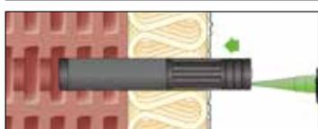
Aufgesteckten RECA Dimos Anker vorsichtig in das gereinigte Bohrloch schieben bis die Mindestverankerungstiefe von 125 mm im Lochstein erreicht ist.
